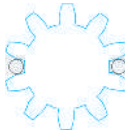
Nasadki kuliste do pomiaru uzębienia zewnętrznego
